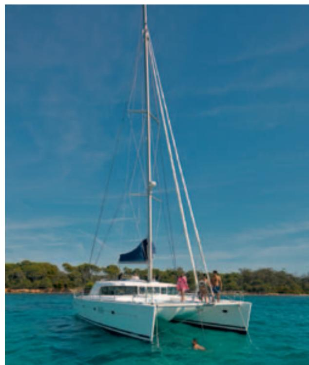
Equiper les mâts des grands Lagoon de bas haubans permet de simplifier le gréement et la circulation des voiles. Mais cette configuration n'est réaliste que sur des bateaux de taille supérieure à 42 pieds. En dessous, les bas haubans entravent les passavants et la circulation à bord. C'est pourquoi le Lagoon 400 est équipé d'un gréement tridimensionnel.
